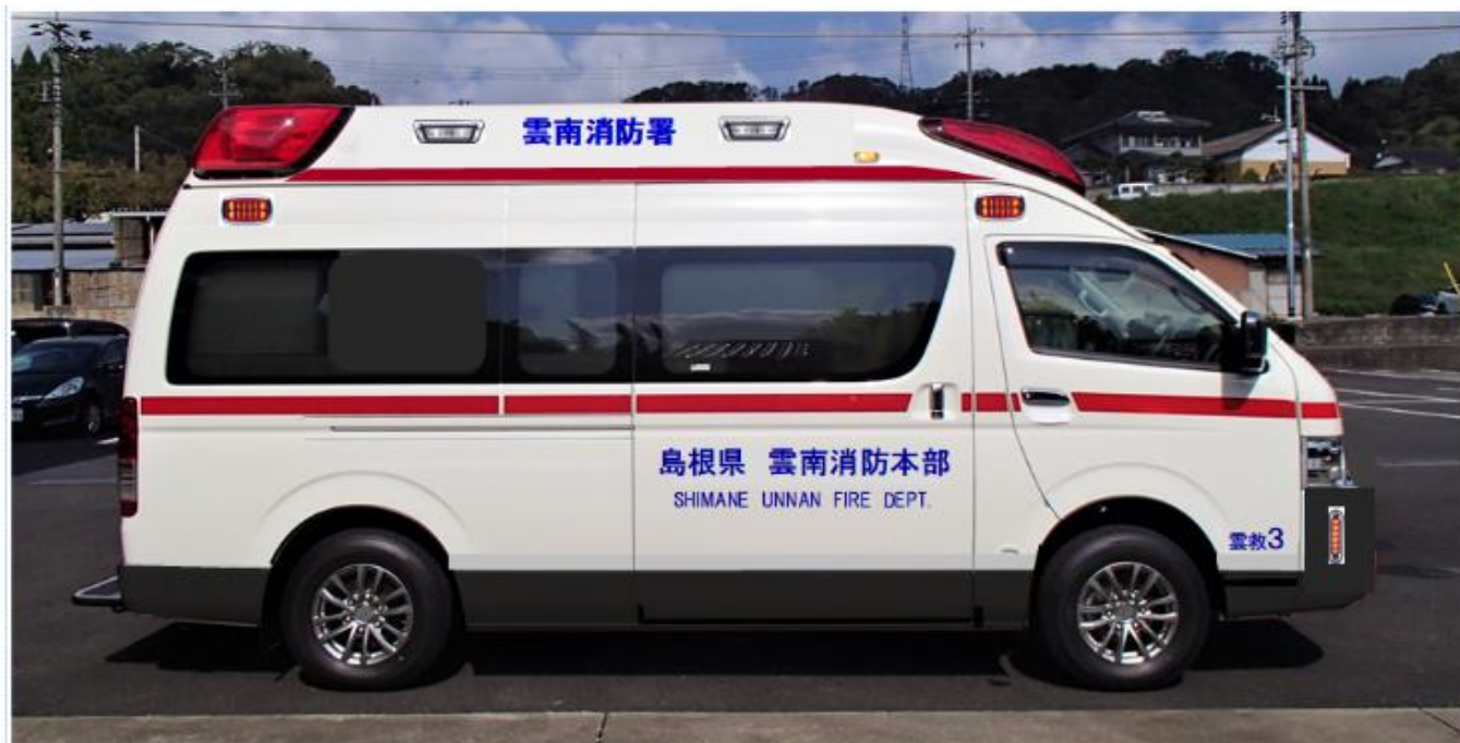
側面は全て再帰性反射材を使用
