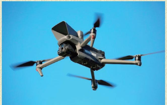
導入したドローンは、上空から災害現場等を視認できるほか、搭載されている赤外線カメラを通して温度を可視化する機能を有しており、災害現場の温度測定や救助捜索では体温を感知できるなど、災害現場の様々な情報をより早く確実に収集することができます。
