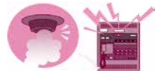
自動火災報知設備
