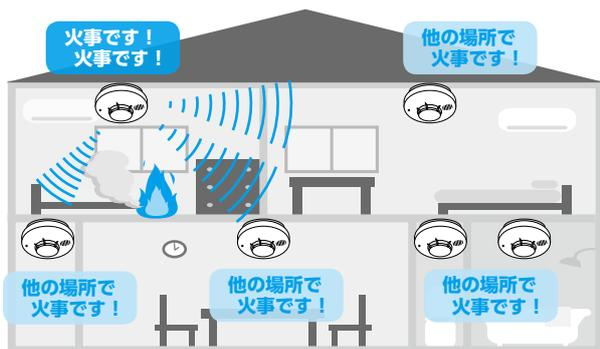
連動型の住宅用火災警報器が火災を感知すると、他の場所に設置されている住宅用火災警報器も連動して警報音を発します。
